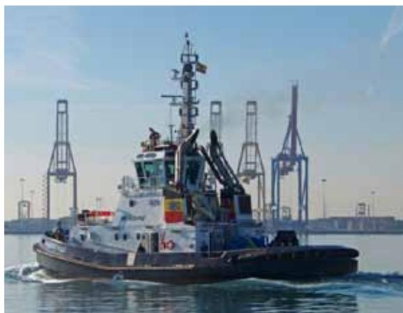
I due rimorchiatori sono del tipo Tractor, con propulsione Voith Schneider e potenza di 6500 BHP, possono raggiungere una velocità di 12,5 nodi, hanno una capacità di tiro a punto fisso di 62 tonnellate, ed hanno le seguenti dimensioni: 29,50 m lunghezza x 11,00 m larghezza x 4,40 m pescaggio, gross tonnage: 369 GT, portata: 300 dwt.
